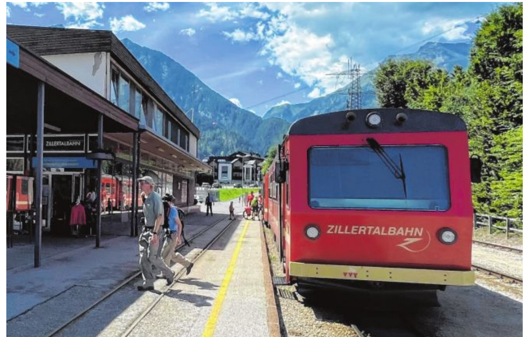
Die Dieselmotoren werden eingemottet, die Zillertalbahn auf eine Akku-Hybrid-Variante umgerüstet. Foto: Dähling
